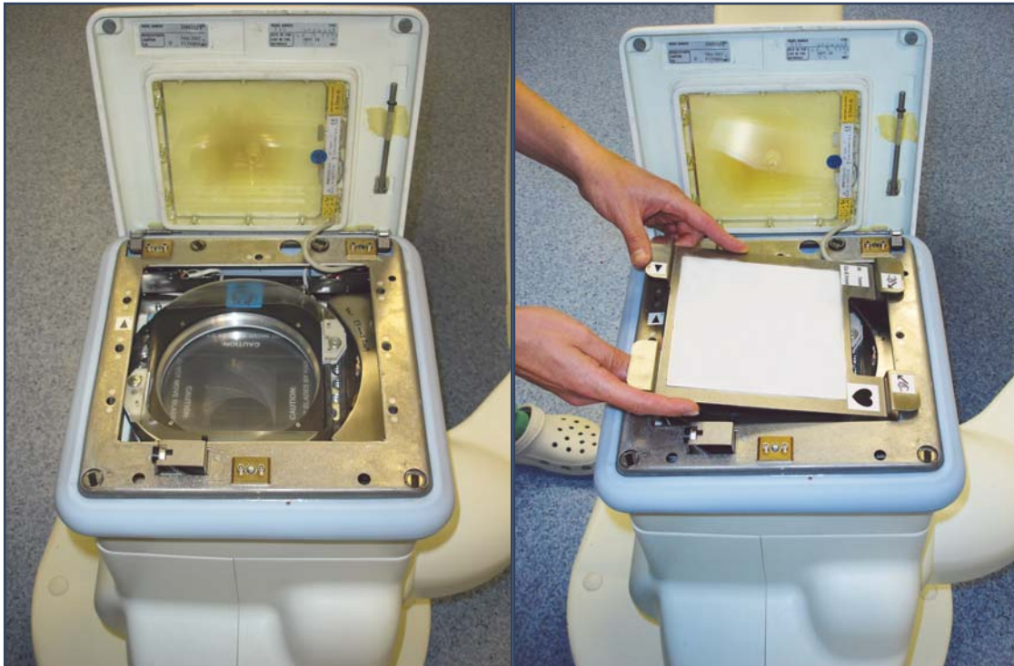
Figure 4. À droite, la mise en place d'un filtre Al/Cu a permis de réduire la dose au patient de 50 % !
